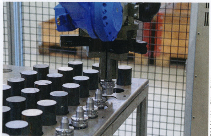
Der Roboter legt ein fertig bearbeitetes Werkstück ab, um anschliessend ein Rohteil zu greifen, um es in die Hauptspindel zu führen.
