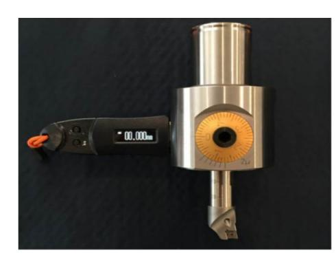
Mit der Digitalisierung des Feinbohrkopfes Vario-Head sind jetzt alle Feinspindelwerkzeuge von Swisstools in digitaler Ausführung verfügbar. Die Maßeinstellung erfolgt weiterhin durch Verstellung mit einem Inbusschlüssel an der Skalaschraube.
