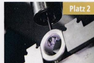
**Zerspantung** – vs. Kempf hat ein ganzheitliches Entgratsystem von Xebec im Produktportfolio für die immer diffiziler werdenden Entgrataufgaben. Der Xebec Back-Burr Cutter ist eine innovative Bohrungsentgratlösung, die eine Synergie aus Kugelfräser und NC-Datensatz bil-
